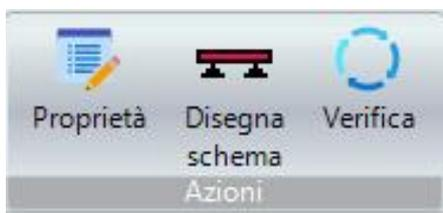
Con il comando “Proprietà” possiamo visualizzare la scheda di proprietà dello schema.
