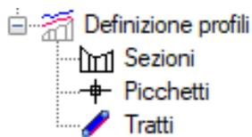
Una volta creati i profili il raggruppamento dei profili conterrà tutti i profili definiti ai quali potranno essere modificati i parametri generali come scala e fondamentale e si potrà procedere alla visualizzazione di ognuno di essi per apportare le necessarie modifiche.
