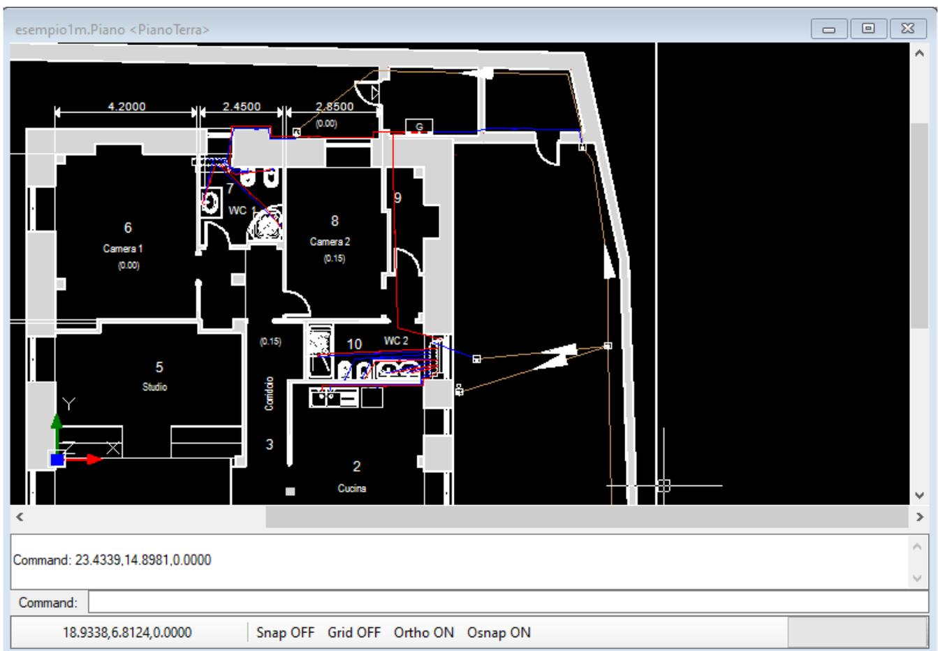
E' possibile, prima di inserire gli elementi dell'impianto, impostare come sfondo una planimetria esistente sul piano di progetto in modo da inserire gli elementi nella posizione corretta, come si può vedere nell'immagine.
