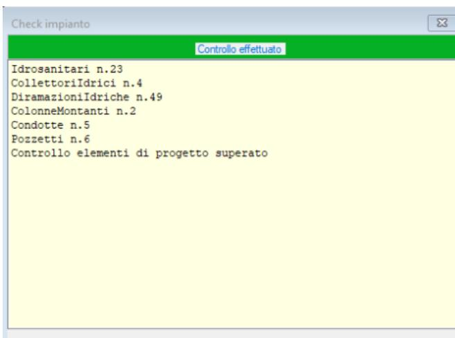
Dopo aver inserito il modello ed aver eseguito un check con risultato positivo è possibile calcolare la rete.
