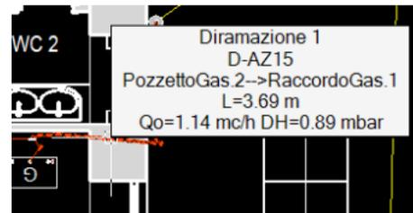
eseguito un calcolo con esito positivo, in tutte le liste degli elementi e nelle relative schede di proprietà verranno indicati i valori della portata volumica, perdita di carico, quota piezometrica e pressione. Gli stessi valori sono visibili direttamente dalla visualizzazione grafica dell'elemento in corrispondenza del tooltip
