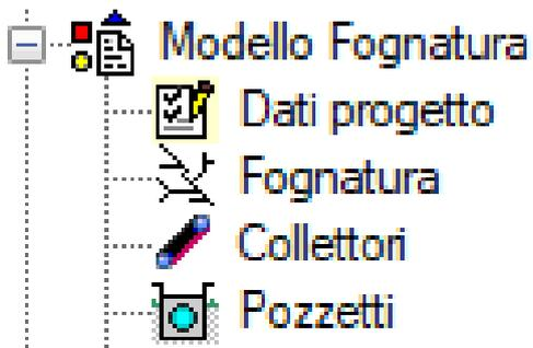
Una volta modellato il territorio, in modo da aver definito le quote altimetriche su tutta la superficie, è possibile passare alla modellazione della rete fognaria. Per cominciare la modellazione è necessario accedere alla vista grafica della rete. Selezionare il nodo *Fognatura* dall'albero di progetto ed utilizzare il comando "Disegna" dal menù di *Progetto*.
