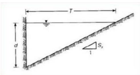
Nota la geometria (larghezze e altezze) ed il coeff. di scabrezza della formula di Gauckler-Strickler è possibile una volta assegnate pendenza e tirante idrico calcolare il deflusso.
