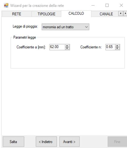
Nella **scheda Calcolo** è possibile impostare il metodo di calcolo e la legge di pioggia: Tali parametri possono essere inseriti anche in un secondo momento.
