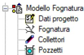
Una volta modellato il territorio, in modo da aver definito le quote altimetriche su tutta la superficie, è possibile passare alla modellazione della rete fognaria. Per cominciare la modellazione è necessario accedere alla vista grafica della rete. Selezionare il nodo *Fognatura* dall'albero di progetto ed utilizzare il comando "Disegna" dal menù di *Progetto*.
