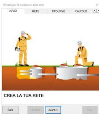
Il wizard per la creazione dell'acquedotto presenta una serie di schede in sequenza che consentono di inserire i parametri più importanti della rete, scegliendoli tra quelli di default, demandando invece ad una fase successiva la selezione di parametri di dettaglio.
