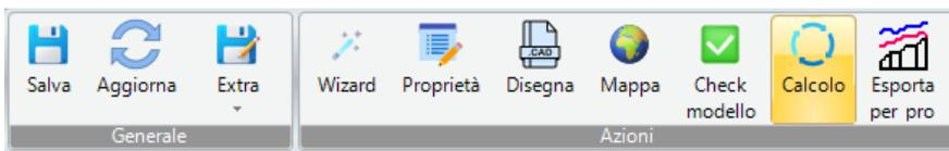
Per lanciare il calcolo dal nodo Acquedotto cliccare sul comando "Calcolo" che visualizza una scheda in cui sono contenute alcune variabili utili per il calcolo (come la formula di resistenza, la precisione) e per le verifiche (pressioni e velocità minime e massime).
