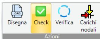
Il comando “Disegna” ci consente di accedere alla finestra grafica per l’inserimento grafico della struttura con l’ausilio di un apposito CAD interno al software.
