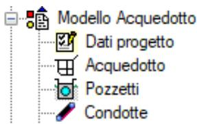
Una volta modellato il territorio in modo da aver definito le quote altimetriche su tutta la superficie è possibile passare alla modellazione della rete idrica. Per cominciare la modellazione è necessario accedere alla vista grafica della rete. Selezionare il nodo *Acquedotto* dall'albero di progetto ed utilizzare il comando "Disegna" dal menù di *Progetto*.
