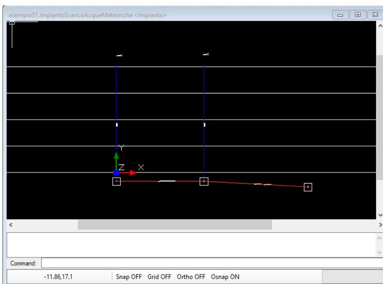
La vista grafica è un cad interno che consente di disegnare i vari elementi sullo schema logico già con i piani e le pluviali inserite automaticamente in base ai dati definiti nel wizard iniziale.
